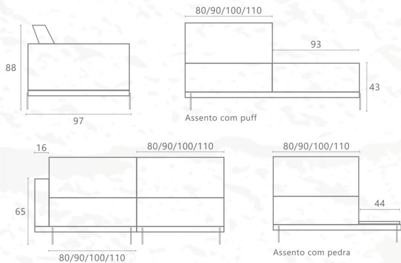
**Estrutura** em madeira de reflorestamento com umidade controlada e imunizada | Nas junções das madeiras estruturais são utilizados **grampos galvanizados** para manter a estrutura firme e resistente | **Espumas** certificadas | **Assentos** em espuma D28 master + fresh, revestida com manta de fibra de poliéster 200gr/m<sup>2</sup> | **Encosto** com almofadas soltas preenchidas com fibra siliconada | **Pés** em aço galvanizado com pintura epóxi | **Detalhe** de mesa lateral com pedra
