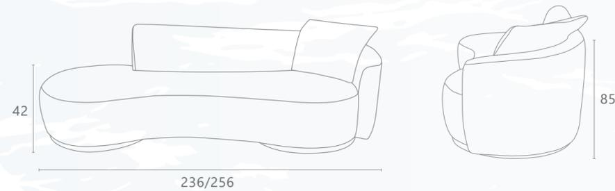
**Estrutura** em madeira de reflorestamento com umidade controlada e imunizada | Nas junções das madeiras estruturais são utilizados **grampos galvanizados** para manter a estrutura firme e resistente | **Espumas** certificadas | **Assentos** em espuma D28 master + fresh, revestida com manta de fibra de poliéster 200gr/m<sup>2</sup> | **Encosto** com almofada decorativa solta preenchida com fibra siliconada | **Base** oval laminada
